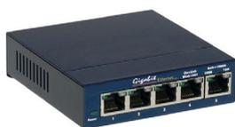
Switch Ethernet industriale per espansione 5 porte LAN, da utilizzare in associazione con Router industriale (art. 1002) nel caso in cui vi fossero più di 4 strutture collegate alla rete.
